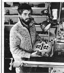
Jeroen Woudenberg toont in zijn werkplaats de 8 kleppskop. Deze doorgezaagde kop laat de toegepaste konstruktie zien.
